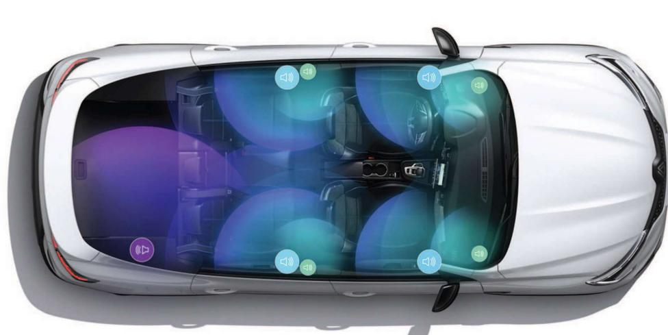
2 tweeters en los laterales del panel de instrumentos, 2 tweeters en los laterales de las puertas delanteras y 2 tweeters, 2 woofers en los paneles de las puertas traseras y 1 subwoofer trasero.
